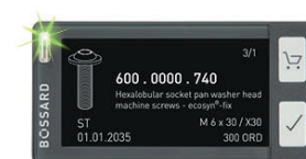
Bossard SmartLabel mit Pick-to-Light / Put-to-Light Funktion
